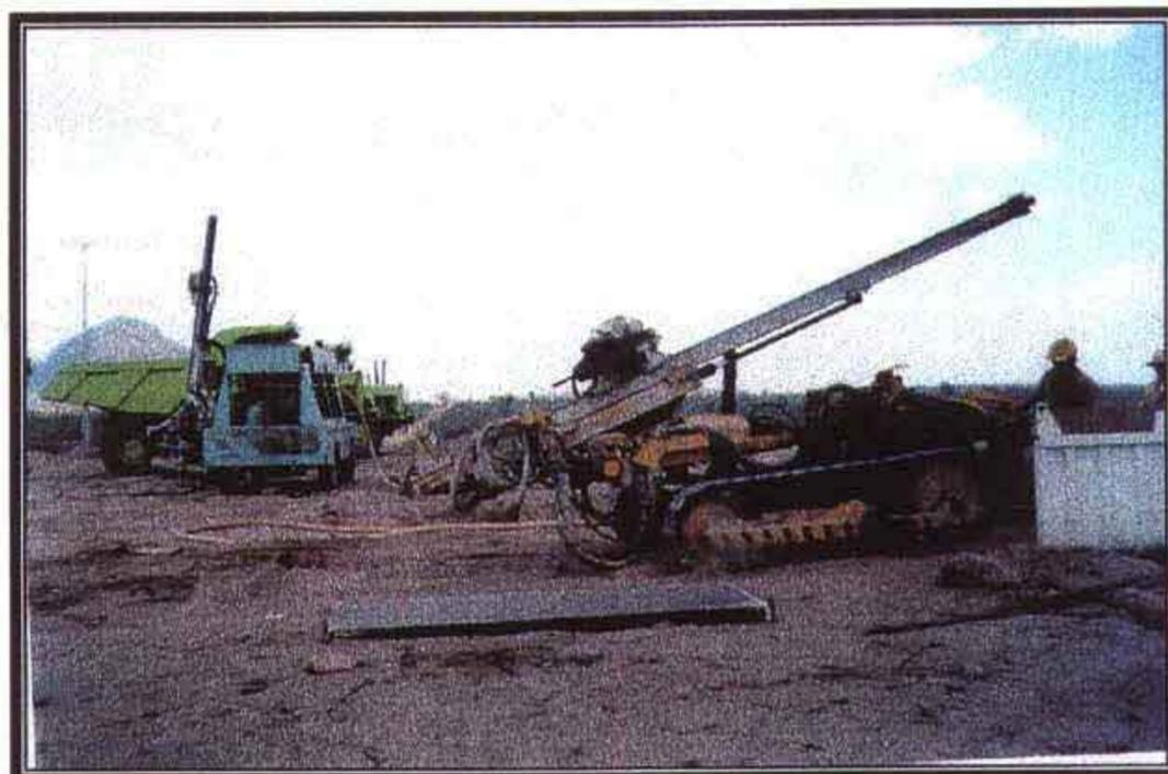
FOTO Nº 05: Equipamento de perfuração de rocha, na área do sangradouro (Rock Drill, compressor e caminhão fora-de-estrada)
