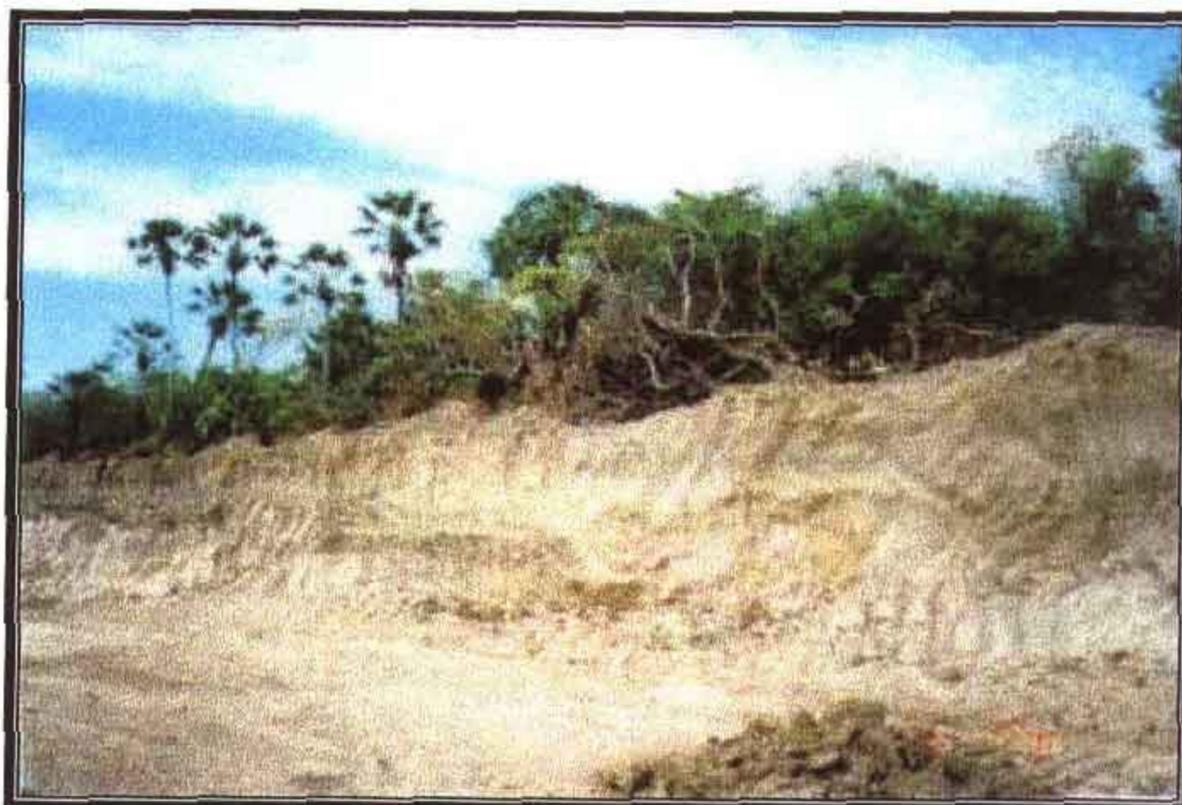
**FOTO Nº 05:** Trincheira de montante caracterização do material escavado.
